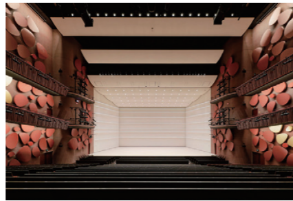
グロービスホール 音響反射板を設置した舞台
