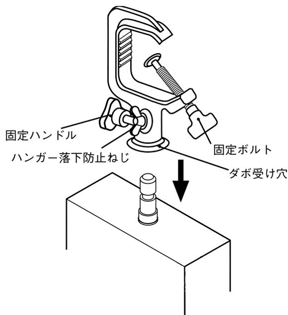
1. ダボが入るように、ハンガー落下防止ねじ、パン固定ハンドルを緩めてください。また、パイプにセットできるように固定ボルトを緩めてください。
