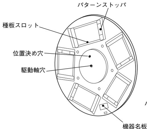
ターレットプレートの種板スロットには、P4 シリーズ (100 X 125mm) の種板を 5 枚装着することができます。
